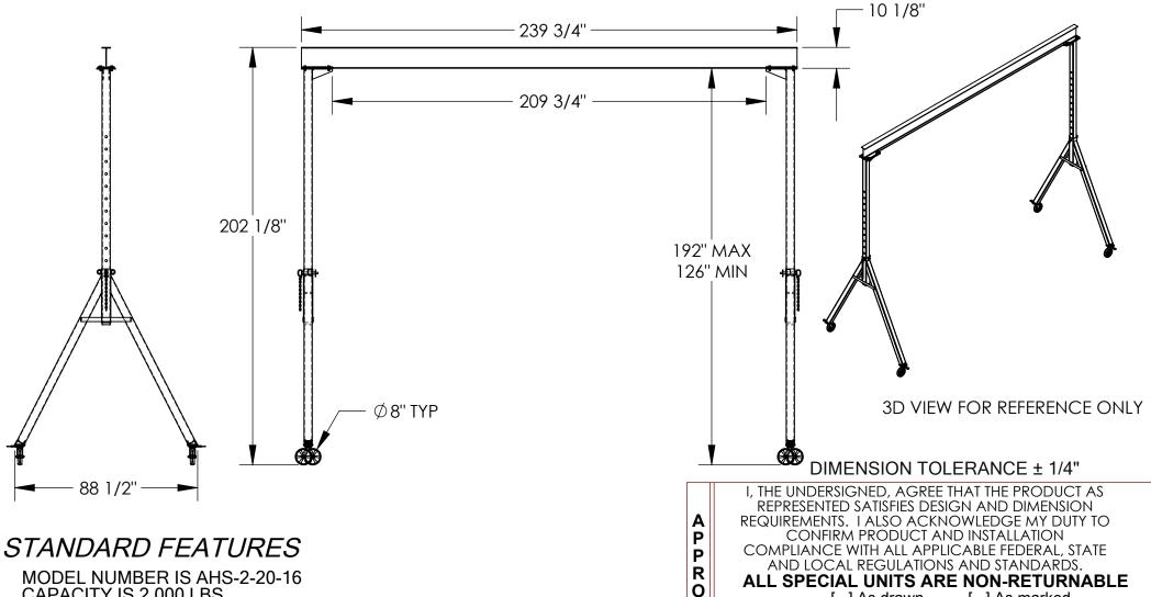
CAPACITY IS 2,000 LBS. BASE WIDTH IS 88 1/2" **OVERALL HEIGHT IS 202 1/8"** OVERALL I-BEAM LENGTH IS 239 3/4" USABLE I-BEAM LENGTH IS 209 3/4" ADJUSTABLE UNDER I-BEAM HEIGHT 192" MAX 126" MIN I-BEAM HEIGHT IS 10 1/8" (4) Ø8" SWIVEL CASTERS WITH
