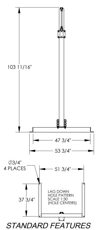
MODEL NUMBER IS CJIB-20 CAPACITY IS 2000 LBS. OVERALL WIDTH IS 53 3/4" STRADDLE WIDTH IS 47 3/4" OVERALL LENGTH IS 65 1/8" USABLE I-BEAM LENGTH IS 54" OVERALL HEIGHT IS 103 11/16" UNDER I-BEAM TO GROUND IS 78 1/2" I-BEAM HEIGHT IS 6"
