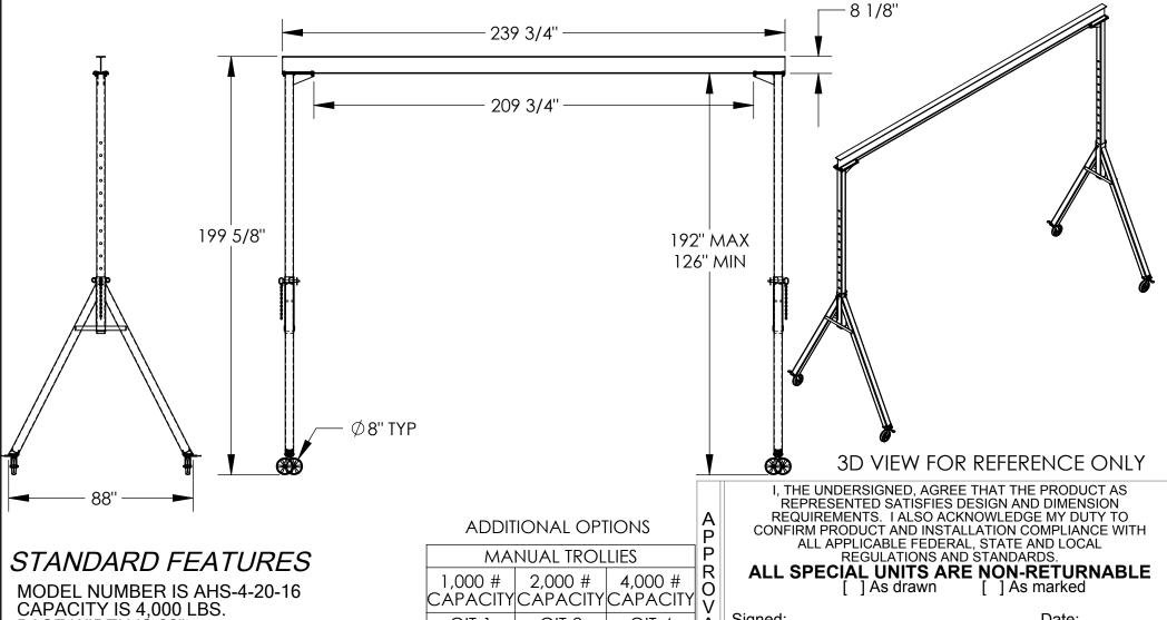
BASE WIDTH IS 88" **OVERALL HEIGHT IS 199 5/8" OVERALL I-BEAM LENGTH IS 239 3/4"** USABLE I-BEAM LENGTH IS 209 3/4" ADJUSTABLE UNDER I-BEAM HEIGHT - 126" MIN. TO 192" MAX. I-BEAM HEIGHT IS 8 1/8" (4) Ø8" SWIVEL CASTERS WITH FOUR LOCKING POSITIONS
